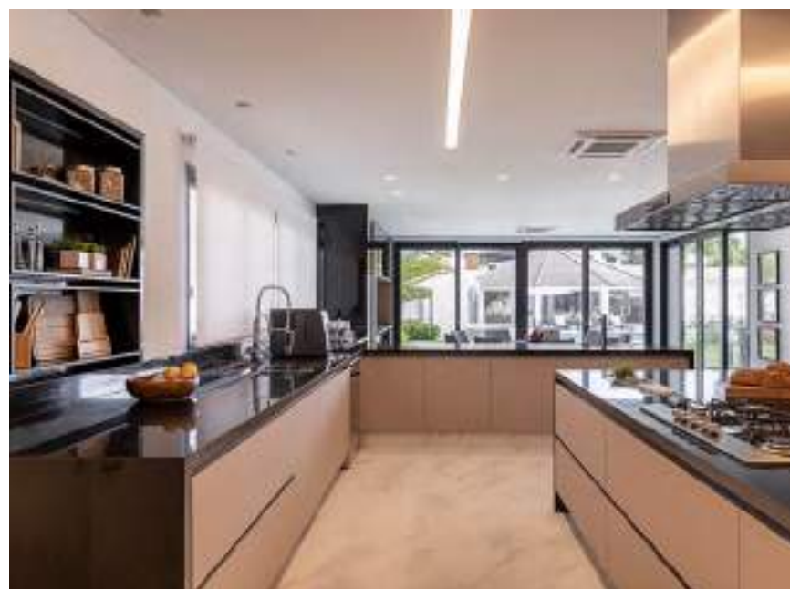
A marcenaria da cozinha tem acabamento em laminado melamínico e borda de MDF em laser em tons nude rosé e preto fosco, além de vidro reflecta bronze e preto. Nas bancadas de granito São Gabriel, cooktop a gás, calha molhada (Top Mármore), que atua como escorredor, e canto para lanches rápidos.
